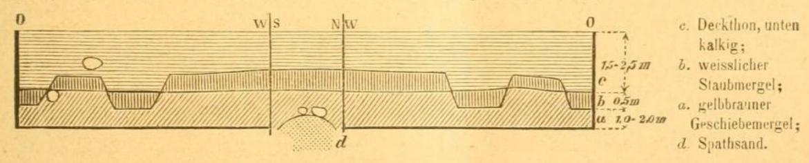
b. und c. sind dünn und eben geschichtet; Mergelconcretionen (sogenannte Kalk-puppen) finden sich im Deckthon, sowie an der oberen Grenze von a.
